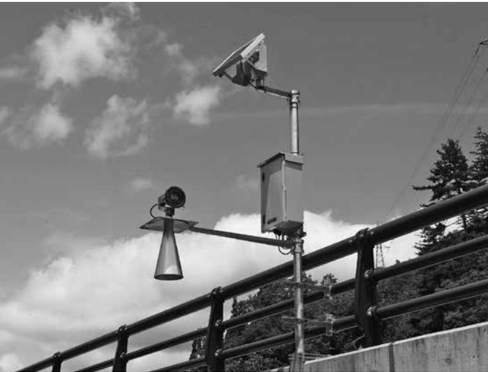
福島県が町内10箇所に設置した「水位計」写真は、山入川鮭立橋に設置されたもの
