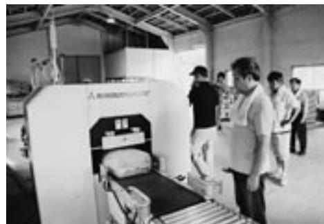
設置している米検査機
